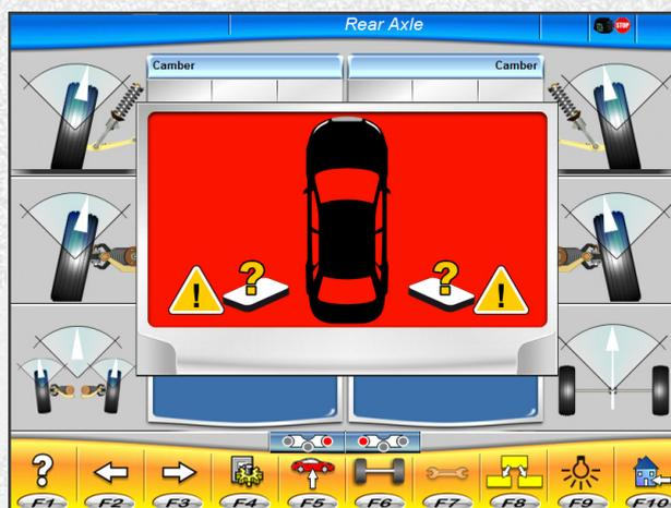
Agire sui tasti PAG\_UP oppure PAG\_DOWN sulla tastiera per attivare la funzione di inseguimento automatico e lanciare ricerca dei target in salita oppure in discesa.
